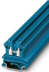
直通式接线端子，标称工作电压: 800 V，额定电流: 24 A，连接量: 2，接线方式: 螺钉连接，额定接线容量: 2.5 mm<sup>2</sup>，横截面: 0.2 mm<sup>2</sup> - 4 mm<sup>2</sup>，安装方式: NS 35/7,5，NS 35/15，NS 32，颜色: 蓝色
