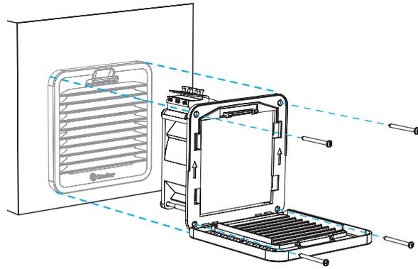
La fixation par clip uniquement est optimisée pour une épaisseur de tôle de 1.5mm.
