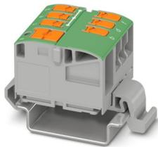
接线板，标称工作电压: 690 V，额定电流: 24 A，连接量: 7，位数: 1，接线方式: 直插式连接，负载触点，额定接线容量:  $2.5 \text{ mm}^2$ ，横截面:  $0.14 \text{ mm}^2 - 4 \text{ mm}^2$ ，线路触点，额定接线容量:  $6 \text{ mm}^2$ ，横截面:  $0.5 \text{ mm}^2 - 10 \text{ mm}^2$ ，安装方式: NS 35/7,5，NS 35/15，颜色: 绿色
