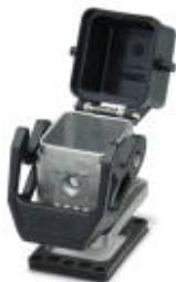
Embase D7, avec étrier longitudinal, matériau: Aluminium coulé sous pression, résistant à l'eau de mer, matériau du couvercle de protection: PA, hauteur: 25,5 mm, presse-étoupe: sans, manchon: non, couvercle de protection: oui, Standard, pour inserts mâles
